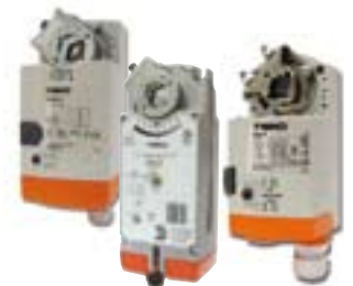
Luchtklep servomotoren Direct gekoppelde luchtklep servomotoren, 5 t/m 34 Nm, met/zonder veerteruggang, 0...10 Vdc, 24V of 230V
